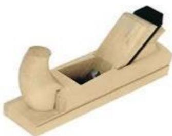
**Рубанок** – предназначен для строгания тонких стружек и получения гладких поверхностей на древесине, а так же для строгания заготовки в нужный размер.
