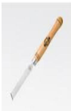
Рейер – полукруглый (желобчатый) резец, по форме похож на обыкновенную полукруглую столярную стамеску. Она имеет полукруглую заточку с внешней стороны с фаской под углом  $25-30^\circ$ . Инструмент служит для первоначальной грубой обточки, рейер применяют также для протачивания полукруглых канавок.
