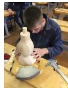
замкнуться в горизонтальной плоскости. При обработке ветвей оставлял припуск для корректировки ветвей. Для окончательной отделки использовал нож, напильники
