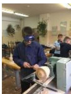
Чаша вазы выполнена в виде цветка, она изготовлена из целого куска дерева размерами 180x100x100 мм. Чашу вытачивал в трубчатом патроне, выполнил черновое точение полукруглой стамеской, косой широкой стамеской заовалил нижнюю часть чаши, для получения внутренней
