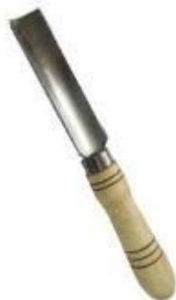
а) Рейер – полукруглый (желобчатый) резец, по форме похож на обыкновенную полукруглую столярную стамеску. Он имеет полукруглую заточку с внешней стороны с фаской под углом  $25 - 30^\circ$ . Инструмент служит для первоначальной грубой обточки, рейер так же применяют для протачивания полукруглых канавок.
